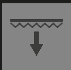
Уложите подложку VINYFLEX на основание так, чтобы края различных полотен плотно соприкасались друг с другом. Фольгированная сторона должна быть обращена к напольному покрытию
